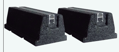
Podstawa pod jednostkę zewnętrzną absorbująca hałas i wibracje Wymiary (wys. x szer. x głęb.): 600 x 95 x 130 mm Dopuszczalne obciążenie robocze: 500 kg
